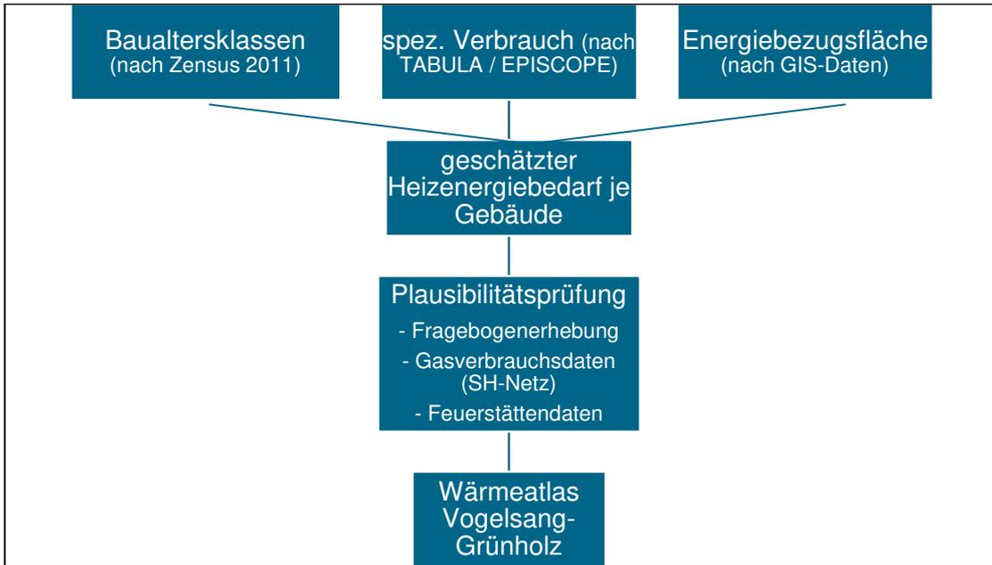
Abbildung 7-13: Vorgehensweise zur Erstellung der Wärmeatlasses
